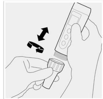
12.2 So tauschen Sie die Elektrode aus: 1) Nehmen Sie die Elektrodenkappe ab; 2) Schrauben Sie den Elektrodenring ab; 3) Nehmen Sie die Elektrode ab; 4) Schließen Sie die neue Elektrode an (achten Sie auf die Ausrichtung der Elektrode); 5) Schrauben Sie den Elektrodenring fest zu. Weichen Sie die neue Elektrode für 5 bis 15 Minuten in 3M KCL ein. Führen Sie vor der nächsten Messung eine Kalibrierung durch.
